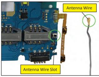
Fig: 3.3.6.8.3 Antenna Wire Slot
