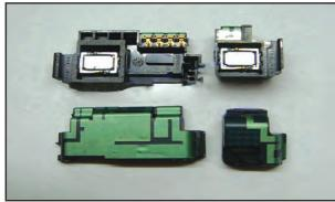
Fig: 3.3.8.1.1 Mobile phone Antenna -1
