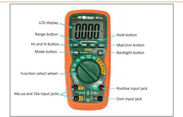
Fig: 3.3.4.10.1 Digital Multimeter
