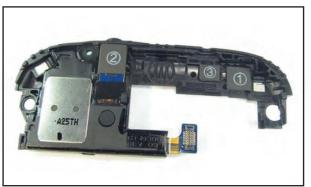
Fig: 3.3.8.1.2 Mobile phone Antenna -2
