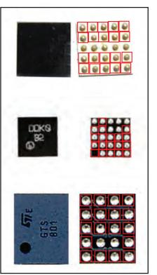
Fig: 3.3.15.8 Keypad IC
