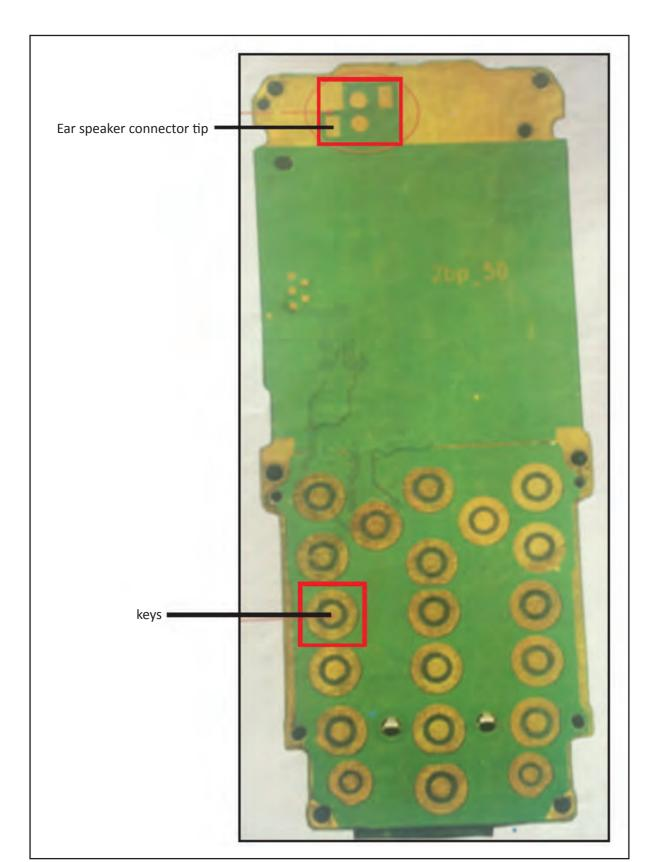
Fig: 3.3.8.13.2 PCB Front Side
