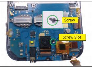
Fig: 3.3.6.8.2 Screw Slot
